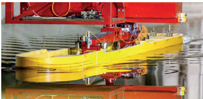
Abb. 7: Schiffsmodell an der PMM-Anlage mit einem statischen Driftwinkel
