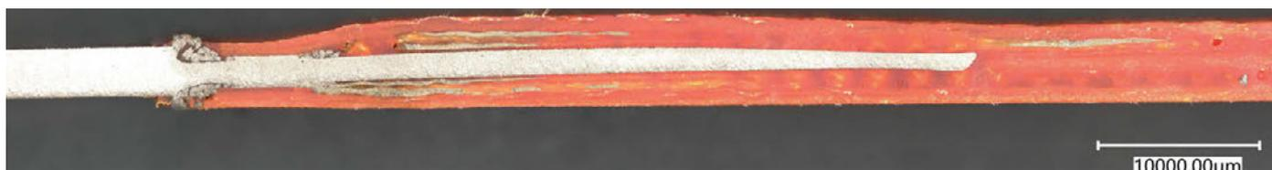
Abb. 3: Querschnitt eines GFK-Laminats mit integriertem FAUSST-Verbinder
