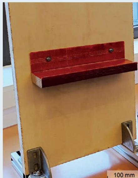
Abb. 3: Hybrid-Faserverbund-Sandwichbauteil mit einem Wandregal aus Benzoxazin-Faserverbund
