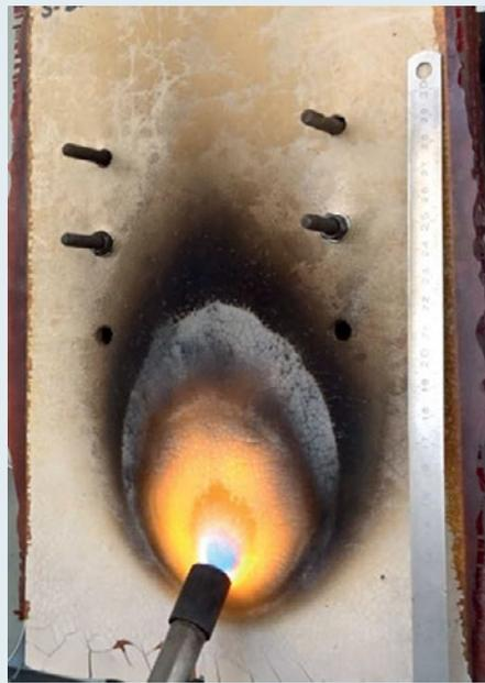
Abb. 2: Sandwichlaminat während des Befeuerungstests in Anlehnung an DIN 4102 beim Mitglied des projektbegleitenden Ausschusses tfc tools for composite GmbH
