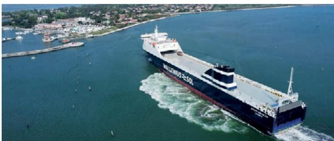
Die rund 204 m lange „South Enabler“ kann bis zu 197 Fahrzeuge an Bord aufnehmen
