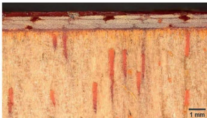
Abb. 2: Beispiele der hergestellten benzoxazinbasierten Leichtbaustrukturen im Querschnitt. Links: von INVENT GmbH gefertigtes GFK-Omegaprofil, rechts: Sandwichplatte bestehend aus FVK-Decklage und Balsaholzkern, hergestellt am Fraunhofer IFAM.
