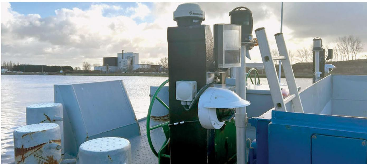
Die PTZ-Netzwerkcameras von Axis Communications liefern die für die Fernsteuerung und Gewährleistung der Schiffssicherheit notwendigen Sensordaten
