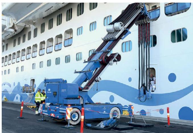
Die „AIDAnova“ ist das erste Kreuzfahrtschiff, das von der neuen Anlage mit Landstrom versorgt worden ist
