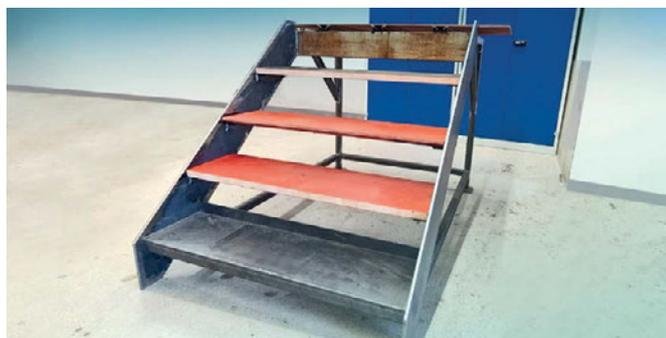
Abb. 7: Demonstrator, mit verschiedenen Stufendesigns: ein Sandwich aus Balsaholz und biobasierten (oberste Stufe) und fossilbasierten Benzoxazin-FVK (zweite Stufe von unten) sowie eine verstärkte GFK-Laminat-Stufe aus fossilbasierten Polybenzoxazin-FVK (dritte Stufe von unten). Die unterste Stufe ist die Referenz-Stahlstufe. Das Treppenpodest ist ebenfalls eine Platte aus verstärktem GFK-Laminat.
